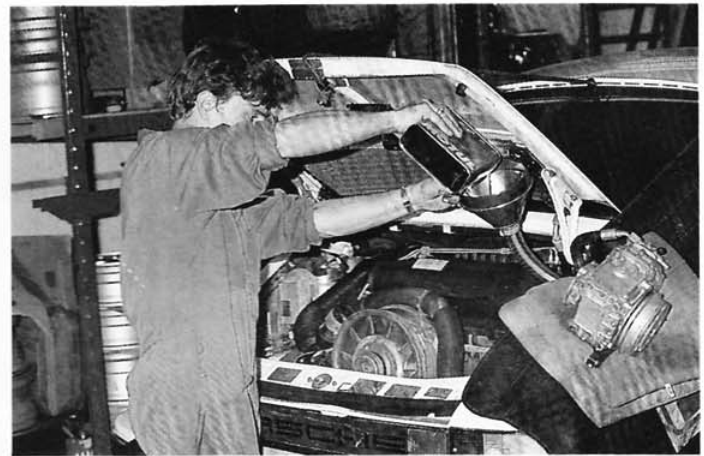
34. Vous l'avez deviné, cette opération nécessite la vidange du moteur, remettre donc 9l d'huile.
