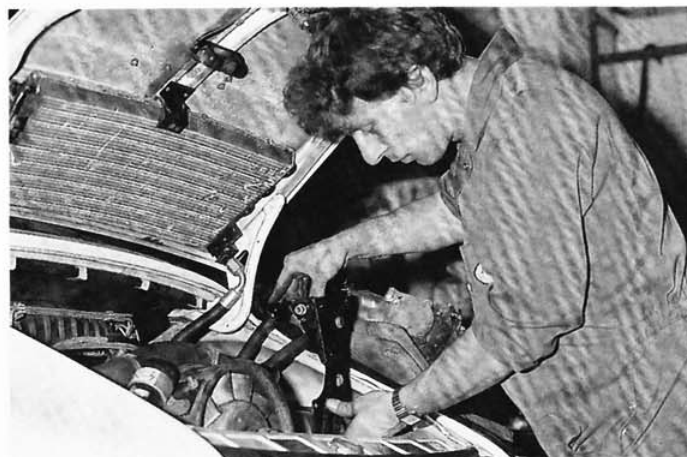
31. Remplacez le support de compresseur, et tous les accessoires, à l'inverse du démontage. Les différents joints doivent être changés.
