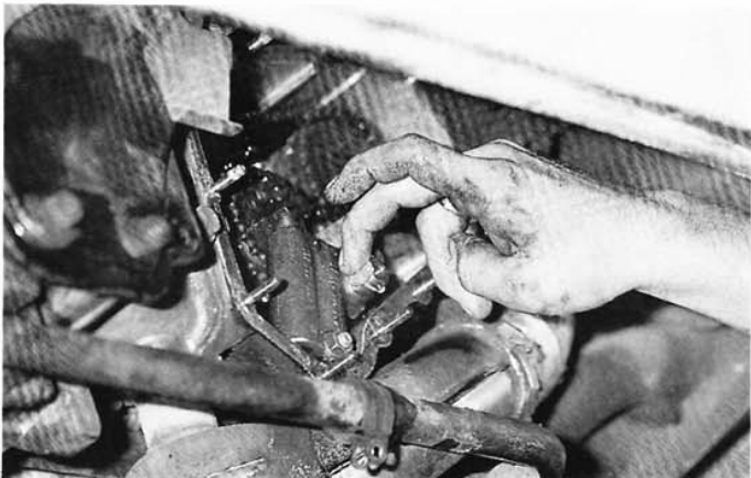
24. Graissez le joint torique avant le remontage des carters.
