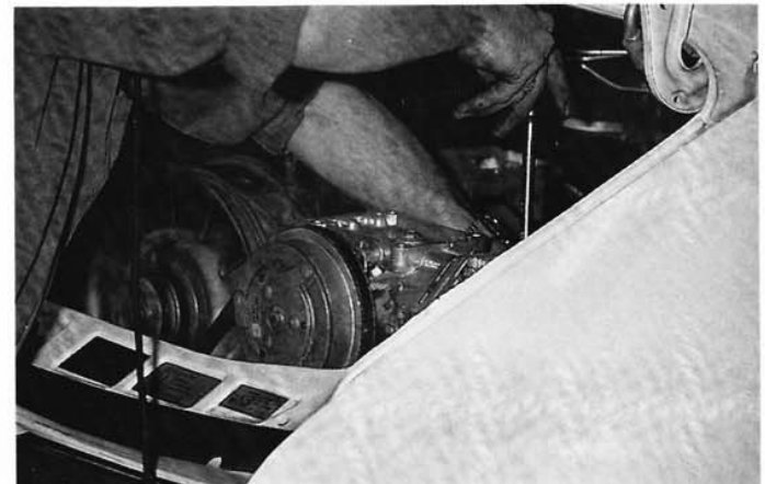
6. Débranchez les tuyaux de compresseur d'air conditionné, et retirez la boulonnerie de fixation du compresseur.
