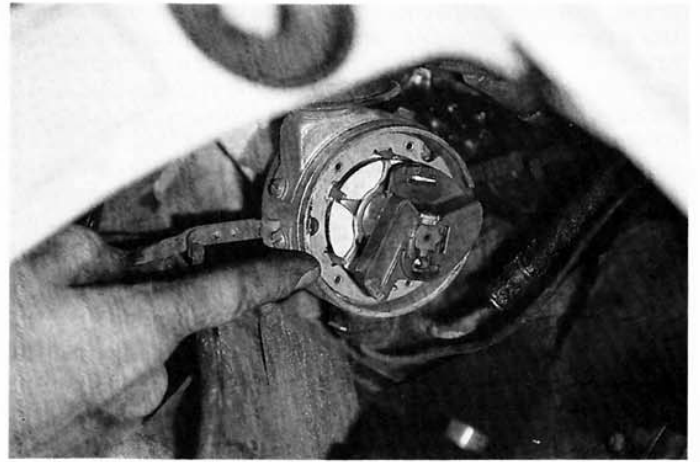
11. Repérez la position du rotor de distributeur. Cette précaution facilitera le remontage.
