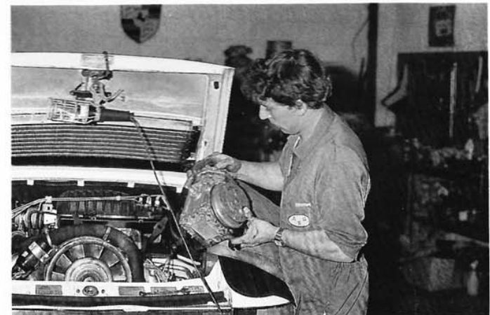
7. Déposez le compresseur.
