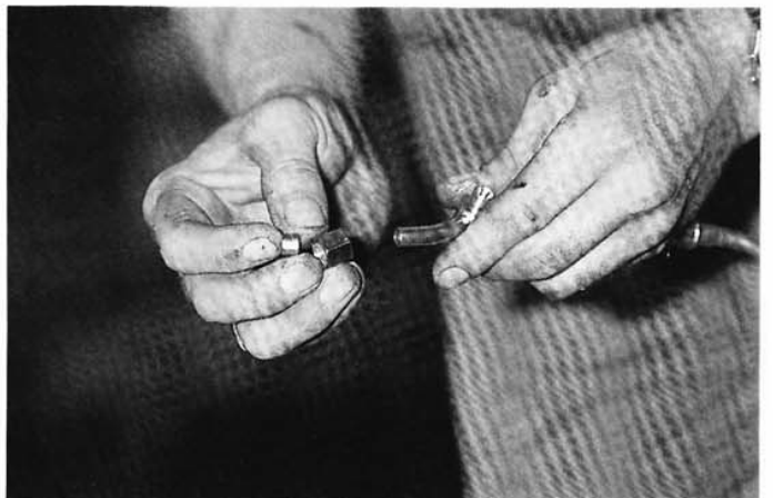
28. Bien placer l'olive de sertissage du conduit d'huile et maintenir le tuyau enfoncé au moment du sertissage.
