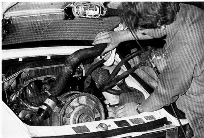
17. Dégagez les manchons de chauffage.
