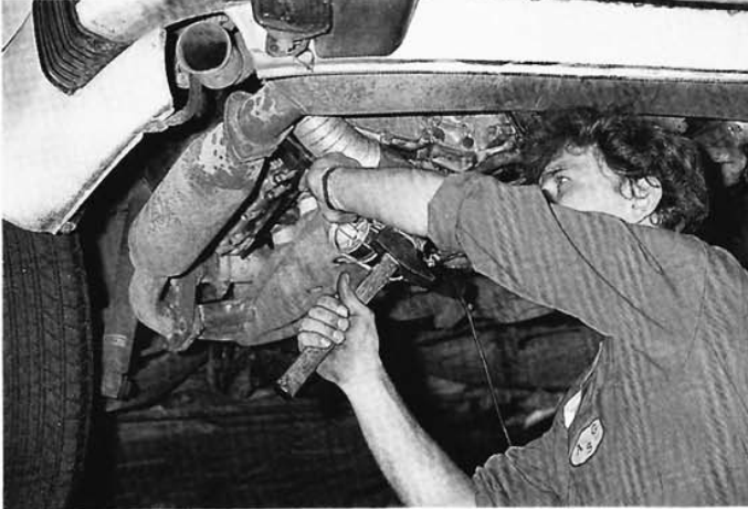
1. Pour avoir accès aux carters de distribution, la dépose des accessoires placés à l'arrière du moteur s'impose. Pour retirer le silencieux, faites sauter les trois boulons de fixation.
