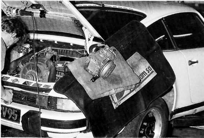
8. Protégez la carrosserie et placez le compresseur sur l'aile.
