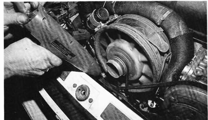
35. Après remontage de tous les éléments, calez l'allumage en ayant pris soin de débrancher la prise de dépression de l'allumeur. Réglez à la lampe stroboscopique l'avance (25° avant le pmh à 4.000 t/min sur la 911SC).
