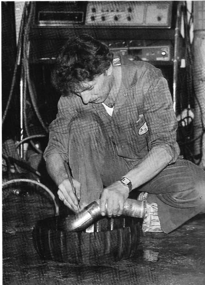
30. Avant le remontage de tous les accessoires, procéder à leur nettoyage.
