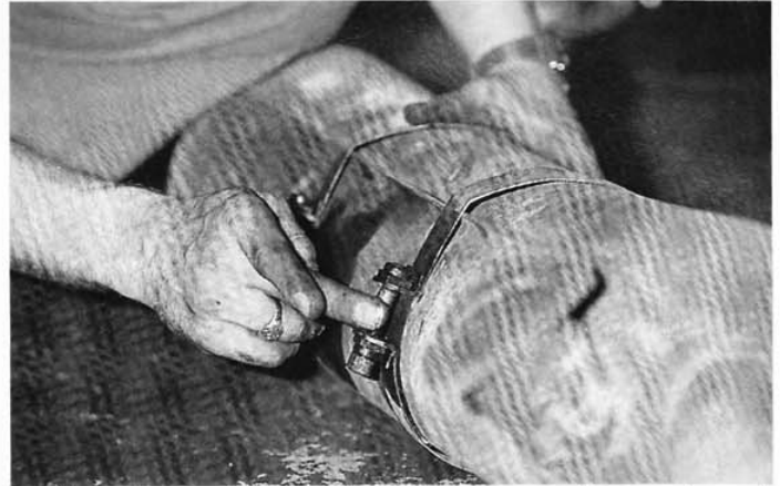
33. Utilisez une graisse haute température pour le remontage de l'échappement.
