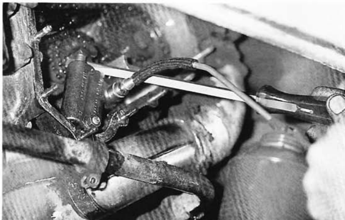
23. A l'aide d'une burette et d'une durite, on injecte de l'huile afin de faciliter la purge et l'amorçage du tendeur.
