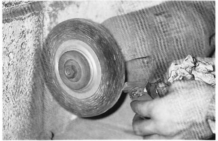
32. Retirez la pellicule d'oxyde du rotor d'allumage.
