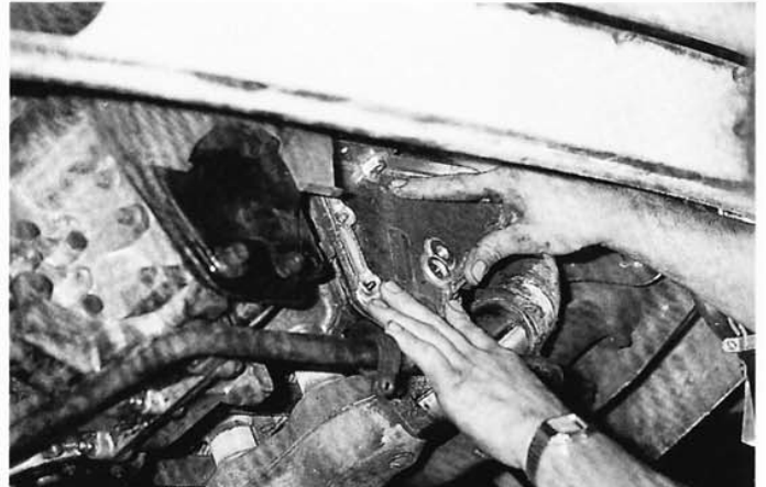
26. Plaquez progressivement le carter afin de placer correctement le joint torique.
