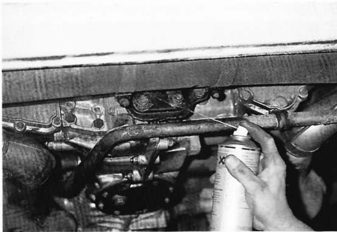
2. Pulvérisez de dégrissant les colliers de fixation de silencieux, ceci facilitera leur démontage.
